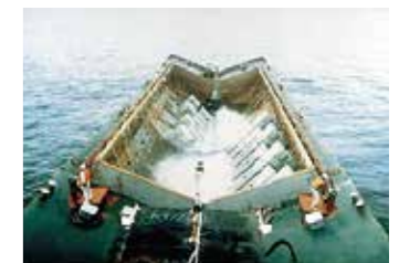
底開バージ船での投入状況
